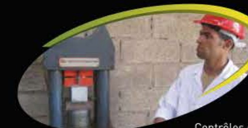
Contrôles des résistances du béton
