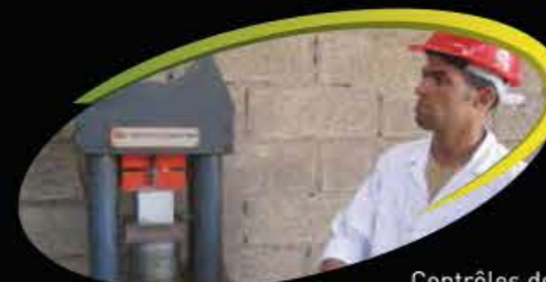
Contrôles des résistances du béton
